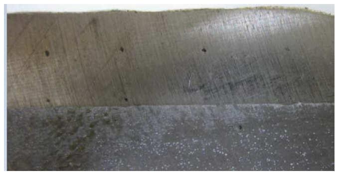
Abbildung 14: Das HoDopp-Verfahren erreicht eine geringe Einschweißtiefe
