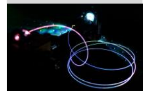
Das LZH testet neuartige Herstellungsverfahren für Glasfasern, die sogar für die rauen Bedingungen im Weltall geeignet sind. (Foto: LZH)
