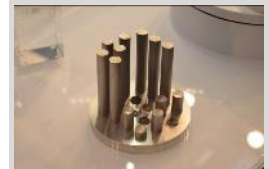
Mittels selektivem Laserschmelzen additiv hergestellte Säulenstrukturen zur Prüfung der mechanischen Stabilität. (Foto: LZH)
