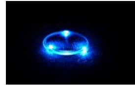
Versuchsoptik zur Erzeugung der “Dritten Harmonischen” in Schichtsystemen. (Foto: LZH)
