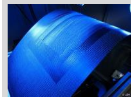
Reparaturvorbereitung eines CFK-Flugzeugteils durch lagenweises Laserabtragen beschädigter Werkstoffschichten. (Foto: LZH)
