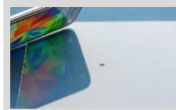
Laserbohren von chemisch vorgespanntem Dünnglas. (Foto: LZH)
