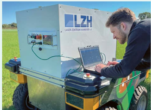
Unkrautbekämpfung im Grünland: Das im Projekt GROW entwickelte Lasersystem im Einsatz bei einem Feldtag.
