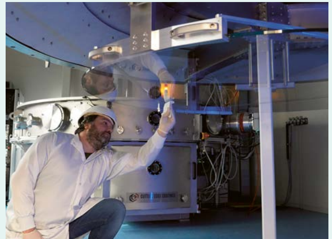
Blick in die IBS2000-Anlage, mit der bis zu zwei Meter-große Optiken beschichtet werden können.
