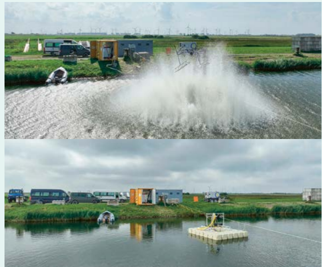
Bei Sprengversuchen in 5 Meter Wassertiefe kam es bei der konventionellen High-Order-Detonation zu einer großen Wasserfontäne (oben). Diese blieb bei der Entschärfung mit dem vom LZH entwickelten Verfahren aus (unten).
