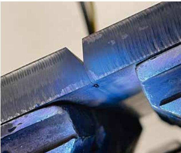
Das Schweißen von Blechen mit einer Dicke zwischen 15 mm und 30 mm ist aufgrund der hohen erforderlichen Einschweiß-tiefen eine anspruchsvolle Aufgabe. Die Wissenschaftler:innen des LZH arbeiten daher an einem Multi-Laserstrahlschweissprozess, der speziell auf diese Herausforderung zugeschnitten ist – mit dem Ziel, eine gleichbleibend hohe Schweißnahtqualität ohne Defekte zu gewährleisten.
