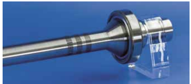
Berührungsfreies Auslesen von Drehwinkel und -moment von Wellen würde mehr Platz im Bauraum schaffen. (Foto: LZH)
