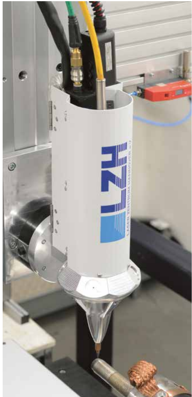
Mit dem vom LZH entwickelten Koax-Kopf kann richtungsunabhängig Draht aufgetragen werden. (Foto: LZH)
