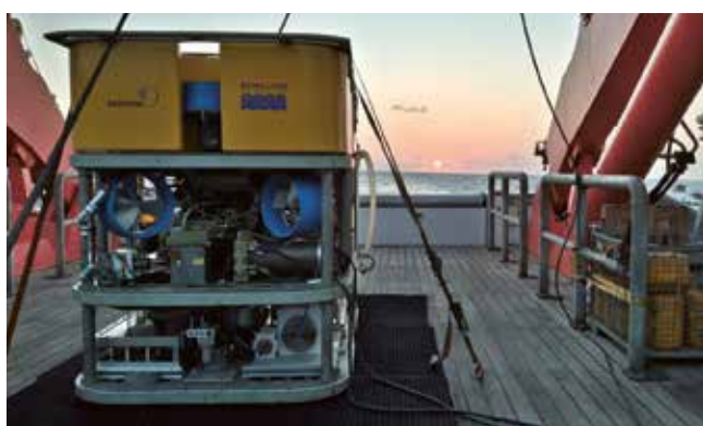
Das LIBS-System des LZH auf dem ferngesteuerten Unterwasserfahrzeug ROV Kiel 6000. (Foto: GEOMAR)
