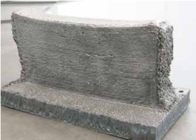
3D-Druck im XXL-Format: Mit dem Verfahren sollen zukünftig Schiffsmotorengehäuse hergestellt werden. (Foto: LZH)
