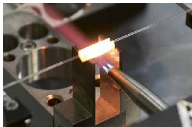
Die Viskosität wird zur Verarbeitung der Glasfaser mittels Wasserstoffflamme eingestellt. (Foto: LZH)
