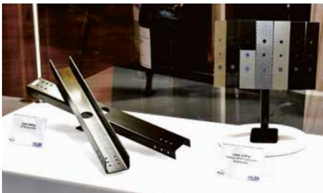
Das laserbasierte Bohrverfahren und die dazugehörige Anlage wurden an sogenannten Cargo Struts aus der Luftfahrt getestet. (Foto: LZH)
