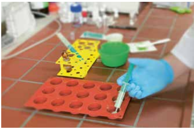
Unter anderem mit frisch hergestellten Knochenzementproben wollen die Wissenschaftler des LZH den Laserabtrag testen und verbessern. (Foto: LZH)
