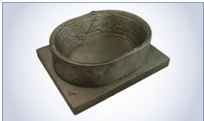
Auf dem Weg zu riesigen Bauteilen: Dieses additiv gefertigte Bauteil ist 18,5 cm breit und innen hohl. (Foto: LZH)
