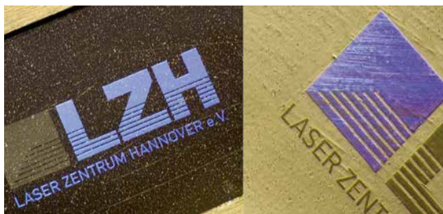
Spritzgussbauteile mit funktionalisierten Oberflächen sollen mit Hilfe von Laseroberflächenstrukturierung wirtschaftlicher hergestellt werden. (Foto: LZH)
