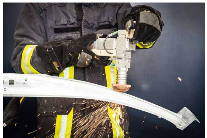
Der handgeführte Laserbearbeitungskopf hilft, Fahrzeuge zügig und sicher aufzutrennen. (Foto: LZH)
