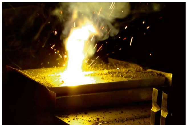
Das LZH hat bereits erfolgreich erste Versuche für den Laserstrahl-Unterpulver-Hybridschweißprozess durchgeführt. (Foto: LZH)
