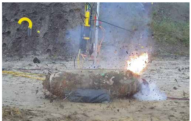
Deflagration statt Detonation: Im Forschungsprojekt DEFLAG konnten die Partner unter Einsatz eines Lasers kontrolliert einen Blindgänger entschärfen. (Foto: LZH)
