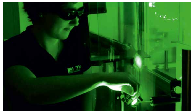
FWJ'lerin Clara beim Justieren eines aus der Messkammer ausgekoppelten Laserstrahls durch eine Blende in eine Strahlfalle. (Foto: Jan Steinbeck, LZH)
