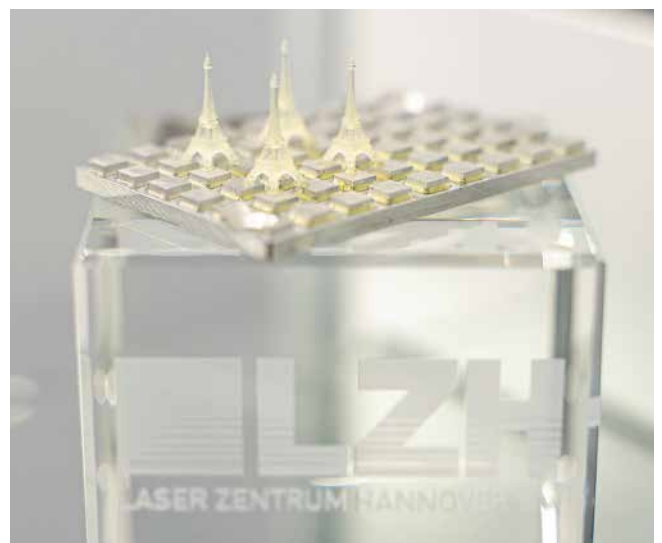
Mit Mikrostereolithographie können hochaufgelöste Strukturen gefertigt werden. (Foto: LZH)
