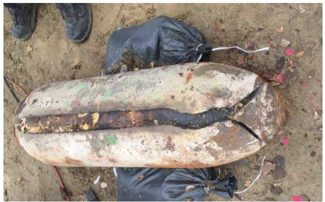
Voller Erfolg beim letzten Feldversuch: Aufgeplatzte Bombe nach der Entschärfung mit einem Laser. (Foto: LZH)
