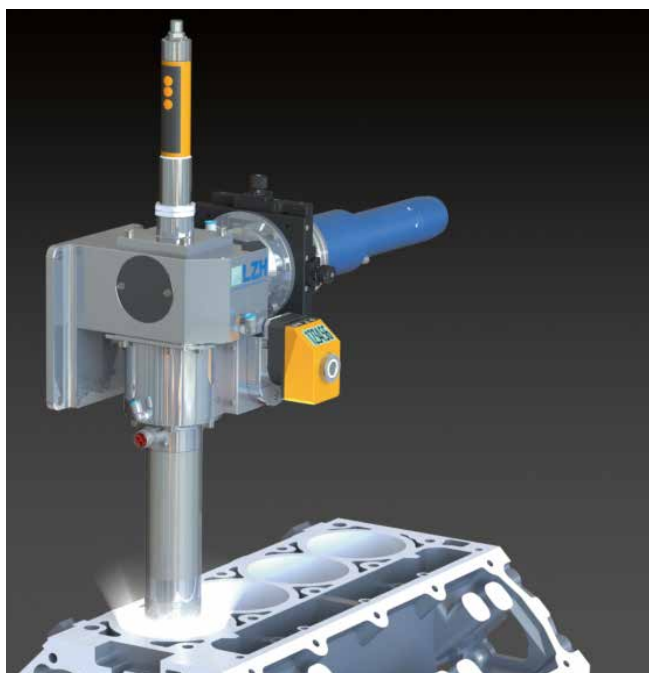
Der neueste Innenbearbeitungskopf (IBK) vom LZH zeichnet sich durch eine integrierte Prozessüberwachung und erleichterte Handhabung aus. (Bild: LZH)
