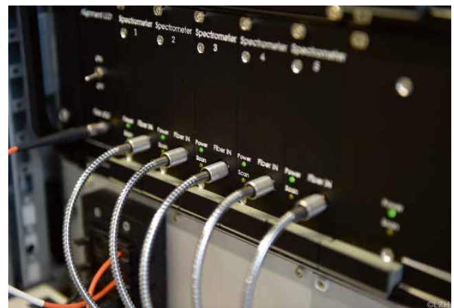
Der vom LZH entwickelte Breitbandmonitor kann bei bestehenden Anlagen als Prozesskontrolle integriert werden. (Foto: LZH)
