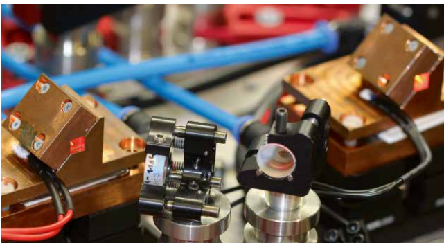
Für die Verstärkung von ultrakurzen Pulsen im Spektralbereich um 2 \mu\text{m} nutzen die Wissenschaftlerinnen und Wissenschaftler am LZH Holmium-dotierte Kristalle. (Foto: LZH)
