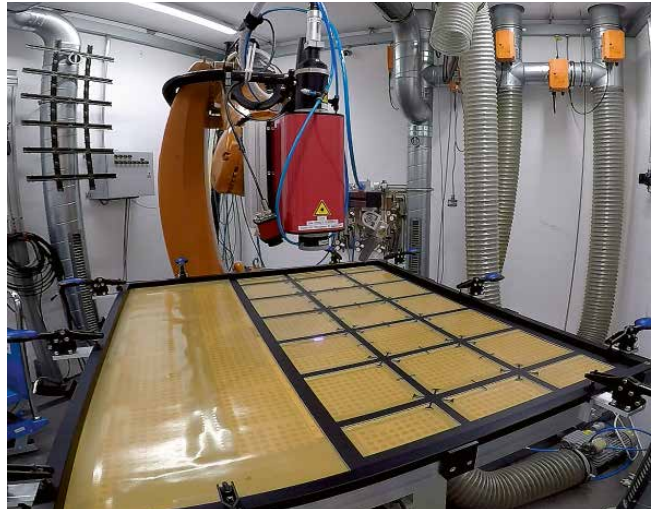
Laserdurchstrahlschweißen großer Versteifungsstrukturen für Anwendungen in der zivilen Luftfahrt. (Foto: LZH)
