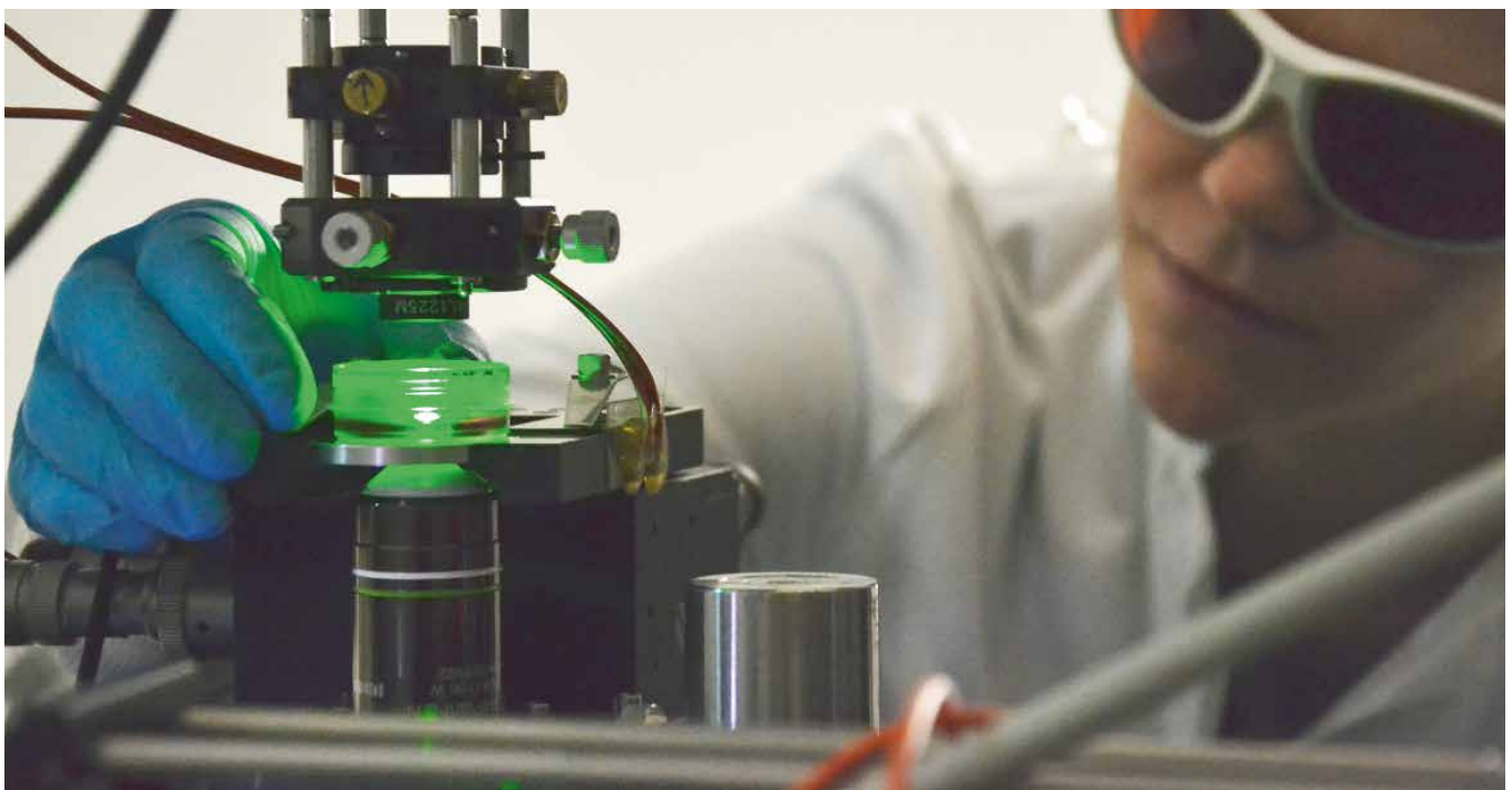
Transmission und Streuverhalten von Lichtleitern aus biokompatiblen Hydrogelen werden hinsichtlich ihrer Einsetzbarkeit in der Implantatentwicklung getestet. (Foto: LZH)
