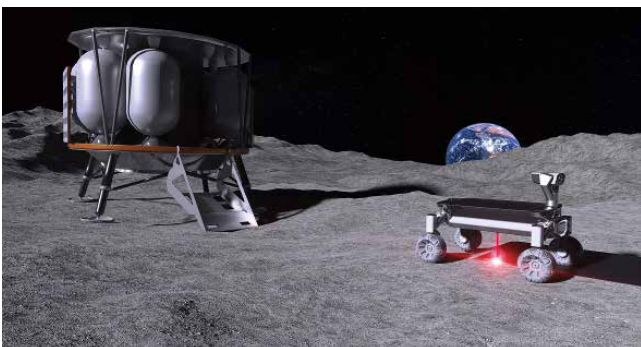
Die MOONRISE-Technologie im Einsatz auf dem Mond. Links eine Mondlandefähre, rechts der Rover mit angeschaltetem Laser beim Aufschmelzen von Mondstaub. (Grafik: LZH)
