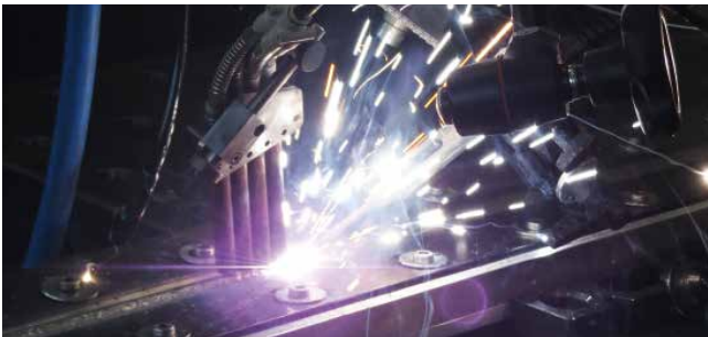
Laserschweißen von Stahl an Aluminium mit hohen Blechstärken für den Schiffbau. (Foto: LZH)
