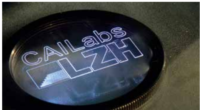
Mit einer Kombination aus Axicon und Laserscanner wird eine effizientere Bearbeitung von Glas möglich. (Foto: LZH)
