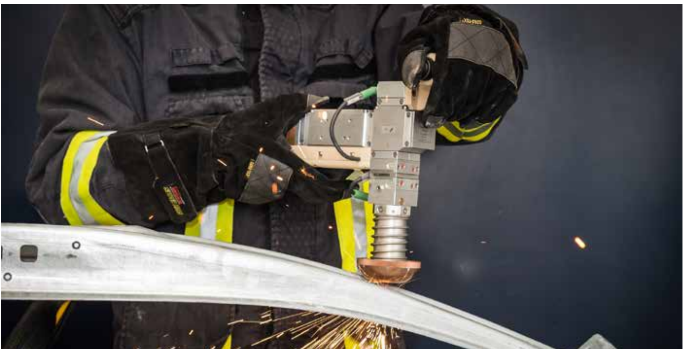
Ein handgeführter Laserbearbeitungskopf könnte zukünftig für eine schnellere Bergung von Unfallopfern eingesetzt werden. (Foto: LZH)
