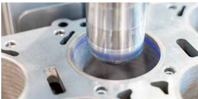
Die rotierende Spitze der Spindel mit dem Laserstrahl wird gesteuert in die Buchse abgesenkt. (Foto: LZH)
