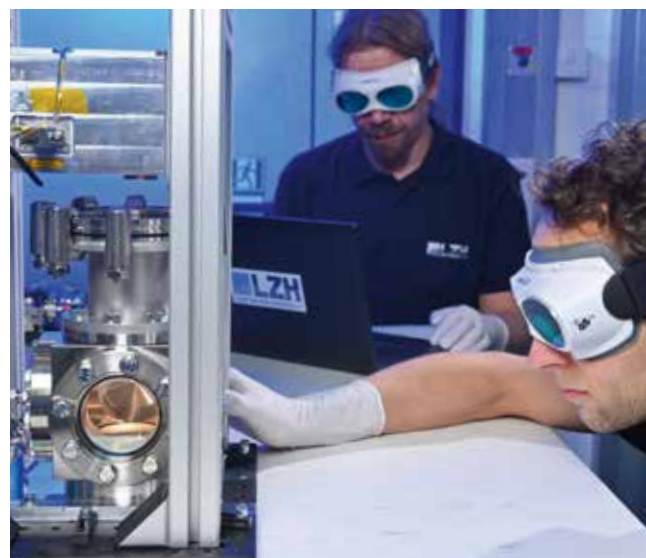
Der MOONRISE-Laser beim Aufschmelzen von synthetischem Regolith. (Foto: LZH)
