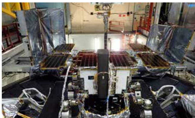
Der ExoMars Rover mit dem MOMA-Laser bestand bei Airbus in Toulouse erfolgreich Thermal-Vakuum-Tests. (Foto: Airbus)
