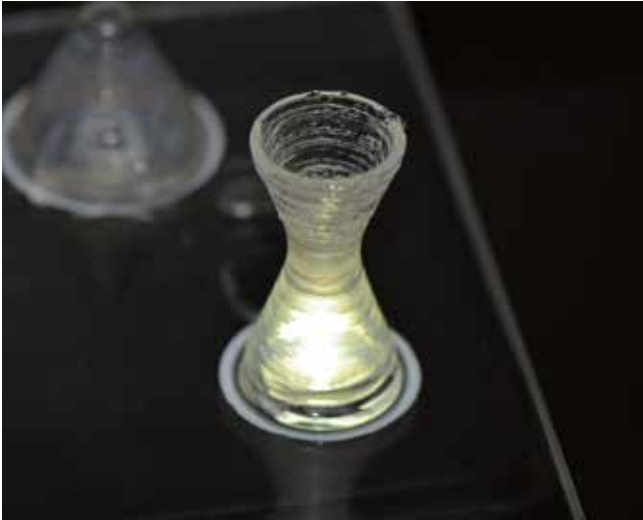
Im Laser Glass Deposition Prozess (LGD) additiv gefertigte Quarzglas-Sanduhr. (Foto: LZH)
