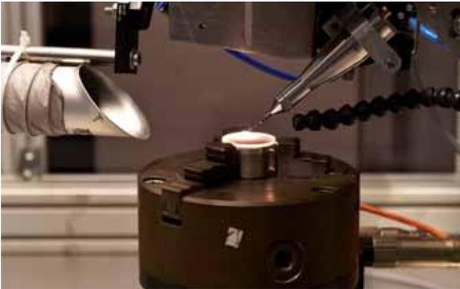
Der 3D-Druck von Glas kann neue Optik-Geometrien ermöglichen.
