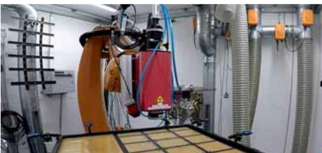
Die neuartigen Verstärkungspaneel werden mit einem vom LZH entwickelten Laserprozess verschweißt.
