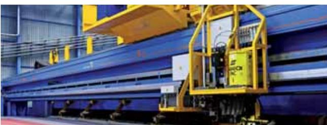
Ziel des Projekts DIOMAR ist es, neue Laserschweißprozesse auf Grundlage von Hochleistungslasern im maritimen Bereich zu etablieren. (Foto: © MEYER WERFT / I. Fiebak)
