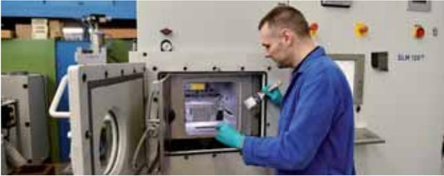
Das LZH erforscht den Einsatz von Standard- und Sondermaterialien für die Additive Fertigung. Dafür stehen zum Teil speziell für das LZH entwickelte Anlagen zur Verfügung.
