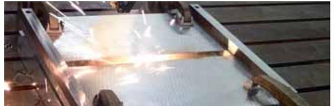
Remote-Laserstrahlschweißen von Stahl-Aluminium-Mischverbindungen.
