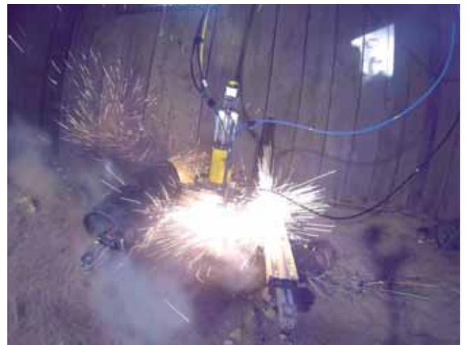
Mit einem laserbasierten Verfahren soll die Entschärfung von Blindgängern sicherer werden.
