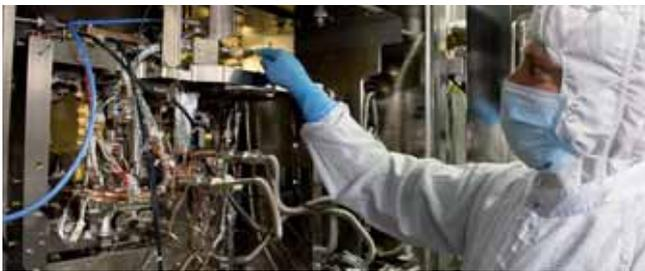
Präzise Montage – ein Techniker der NASA untersucht das MOMA-Instrument während eines Thermalvakuumtests. (Foto: NASA)
