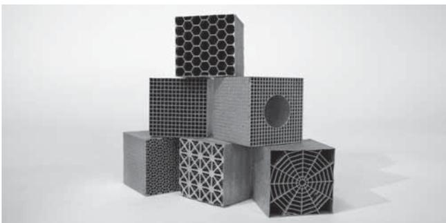
Das IPeG beschäftigt sich unter anderem mit der Konstruktion für die Additive Fertigung, wie beispielsweise die Auslegung innerer Strukturen oder Additive Repair. (Foto: IPeG)
