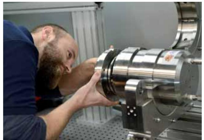
Um die Wechselwirkung von Laserstrahlung mit Material unter Tiefsee-Bedingungen zu untersuchen, arbeiten die Wissenschaftler mit einer speziellen Druckkammer.
