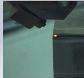
Temperaturgeregeltes Härten einer Bauteilkante
