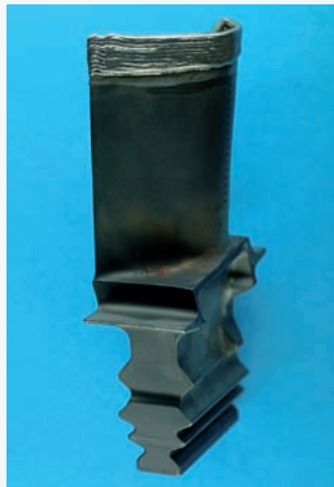
Reparaturschweißte HPT-Schaufel (High Pressure Turbine) aus einer Nickelbasislegierung
