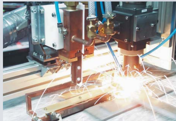
Prozessintegrierte Nachwärmung von Laserstrahlschweißnähten
