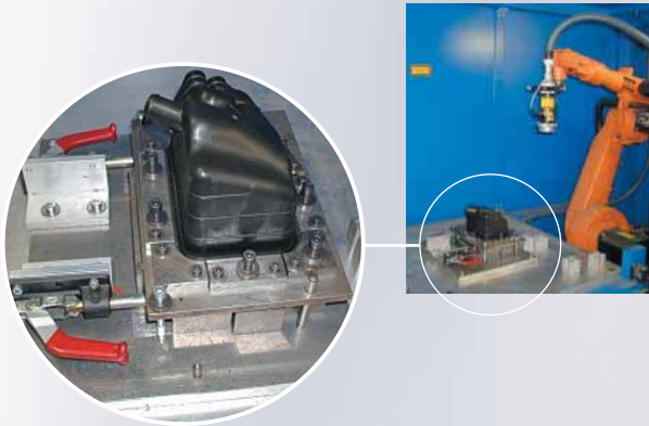
Laserdurchstrahlschweißen von Servoölbehältern (PA6, GF30, PA66, GF25/30, Mann + Hummel Automotive GmbH)
