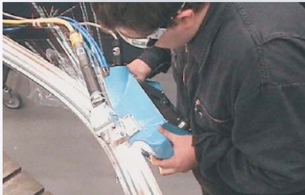
Laserstrahlschweißen von Flanschverbindungen mit teilmechanisiertem Bearbeitungskopf mit integrierter Spannvorrichtung
