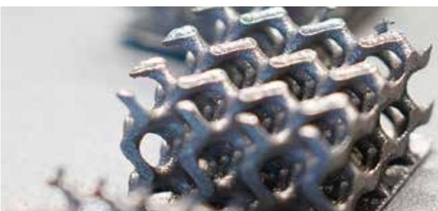
An haltbareren, besonders gut passenden Zahnimplantaten arbeitet das LZH im Rahmen einer DFG-Forschungsgruppe. Dabei wollen die Wissenschaftler:innen Titan-Implantate mit einer innovativen Gitterstruktur additiv fertigen.
