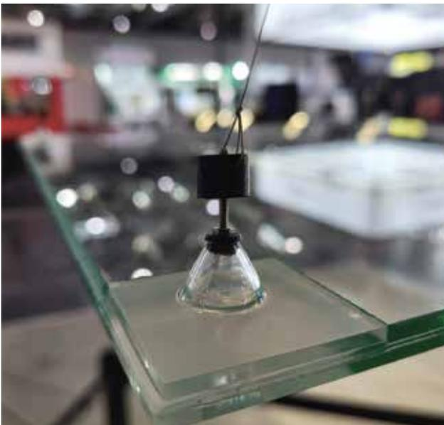
Neue Produkte und Konstruktionen aus Glas ermöglichen: Das ist das Ziel des Projektes **PunktGlaVE (Punktförmige Glasverbindungselemente)**. Glaselemente werden oft im Fassadenbereich oder im Innenausbau eingesetzt und müssen dafür auch miteinander verbunden werden. Dies erfolgt üblicherweise durch Kunststoffverbinder oder metallische Verbindungsstücke, so dass entweder Klebstoffe auf die Glasoberflächen aufgebracht oder Bohrungen in die
