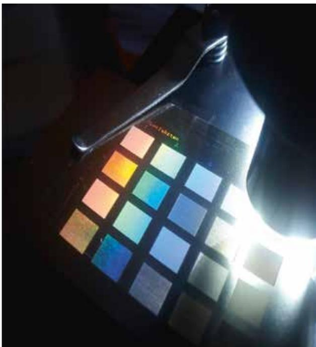
Bei der Mikrostrukturierung von Bauteilen mit dem Ultrakurzpulslaser lassen sich hervorragend funktionale Oberflächen gestalten, zum Beispiel solche, die wasserabweisend sind. Das Verfahren ist allerdings relativ kostenintensiv. Das LZH und Partner haben daher daran geforscht, wie man Spritzgussformen mit dem Laser bearbeiten kann. Ihr Ziel: Die Oberflächen-funktionalisierung mittels Laser auch für kostengünstige Massenprodukte zugänglich zu machen.
