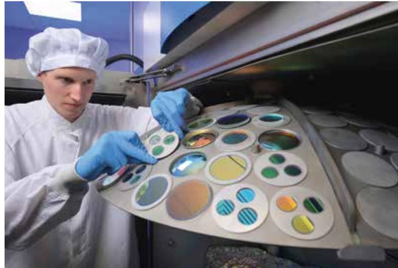
langwelligen infraroten Bereich. Diese sind optimal auf die geplante Anwendung angepasst und für eine lange Lebensdauer optimiert. Wir entwickeln Schichtsysteme, die kommerziell nicht erhältlich sind, arbeiten an einer intelligenten, spektral breitbandigen Monitorierung in Beschichtungsanlagen und daran, neue Beschichtungsmethoden und -dimensionen zu erschließen.
