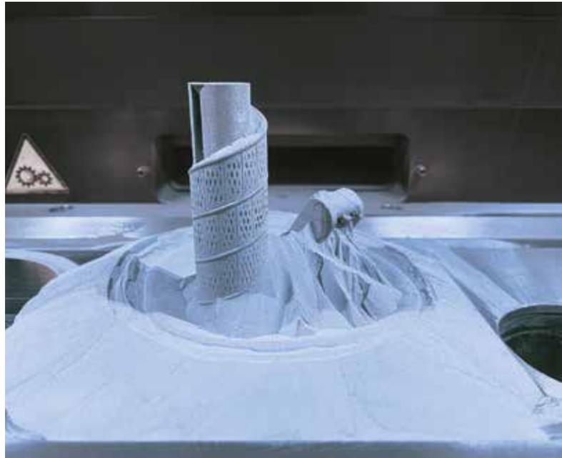
von Glas und Keramik eröffnet viele Möglichkeiten. Hier werden zukünftig neue Anwendungsfelder erschlossen, beispielsweise im chemischen Apparatebau, der Architektur oder der Optik. Wir arbeiten deshalb an der Weiterentwicklung der Fertigungsprozesse, um reproduzier- und automatisierbare Glaskomponenten mit einer hohen Komplexität und optischen Qualität herzustellen.
